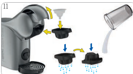
11 Uklonite posudu. Ispraznite i očistite posudu. Izvucite držač kapsule. Uklonite alat za ispiranje. Čuvajte na sigurnom mjestu za kasnije čišćenje ili uklanjanje kamenca. Isperite obje strane držača kapsule svježom pitkom vodom. Ponovno ubacite držač kapsule.
