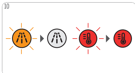
10 Pokazivač procesa uklanjanja kamenca se isključuje, odabir temperature teperi i pali se postojano crveno svjetlo kada je aparat spreman za upotrebu.
