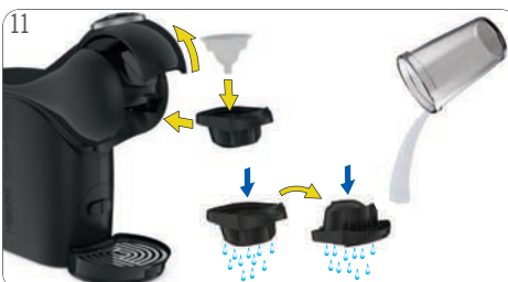
11 Uklonite posudu. Ispraznite i očistite posudu. Izvucite držač kapsule. Uklonite alat za ispiranje. Čuvajte na sigurnom mjestu za kasnije čišćenje ili uklanjanje kamenca. Isprite obje strane držača kapsule svježom pitkom vodom. Ponovno ubacite držač kapsule.
